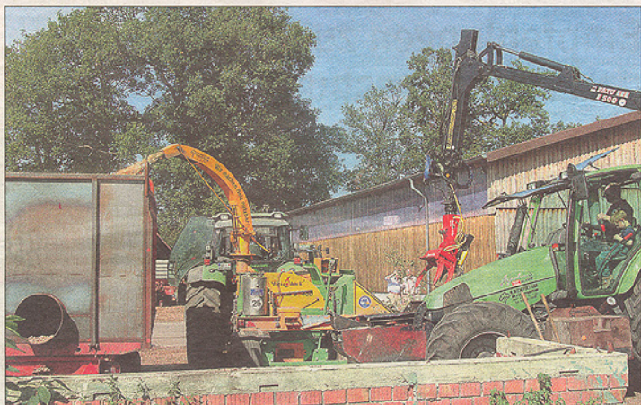
Der Trommelhacker macht hier mit Schwachholz kurzen Prozess. Falls das Hackgut noch zu feucht ist, kann es zum Nachtrocknen direkt auf einen Trocknungswagen geblasen werden.
